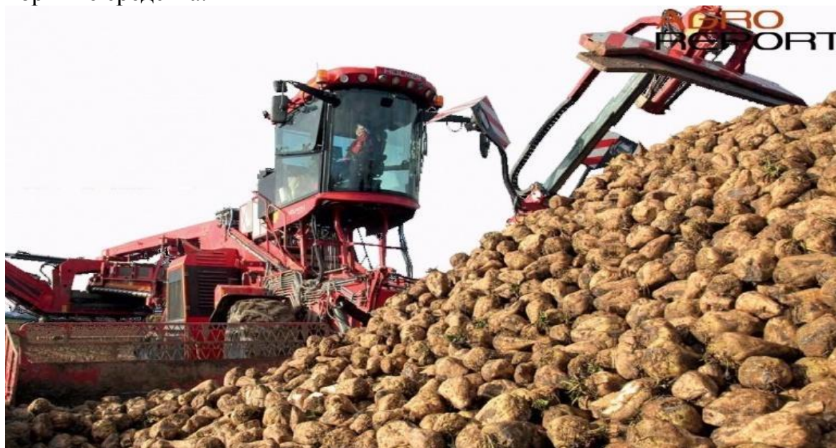
Рисунок 3 – Свеклопогрузчик Terra Felis 3
