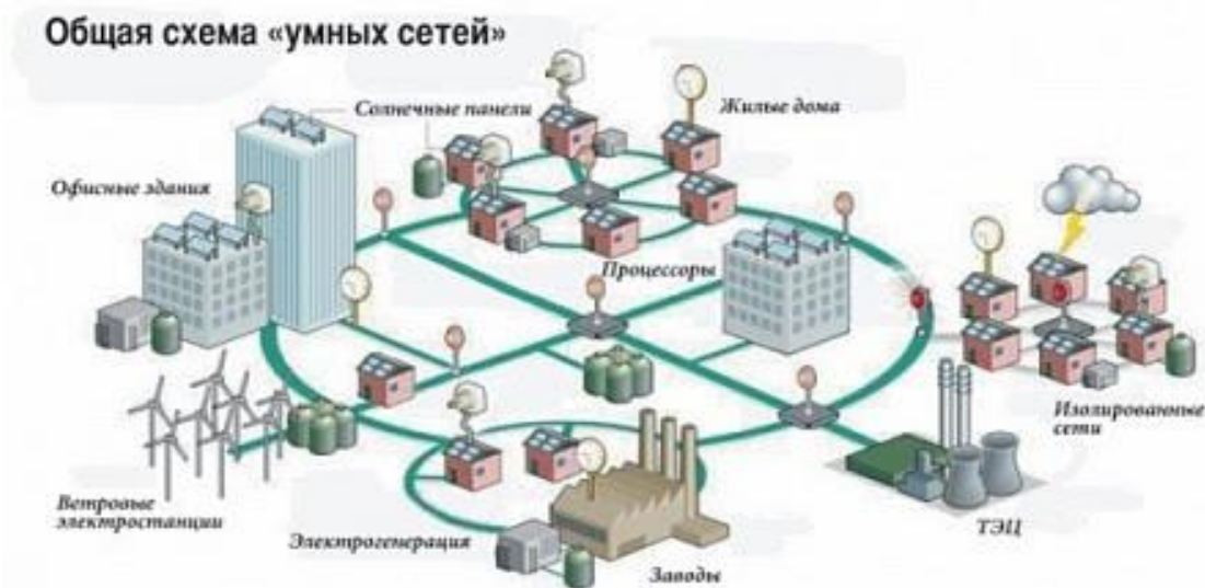
Рисунок 2 – Схема функциональной работы Smart Grid
