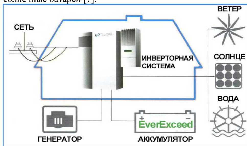
Рисунок 2 – Пути обеспечения резервного электроснабжения дома
