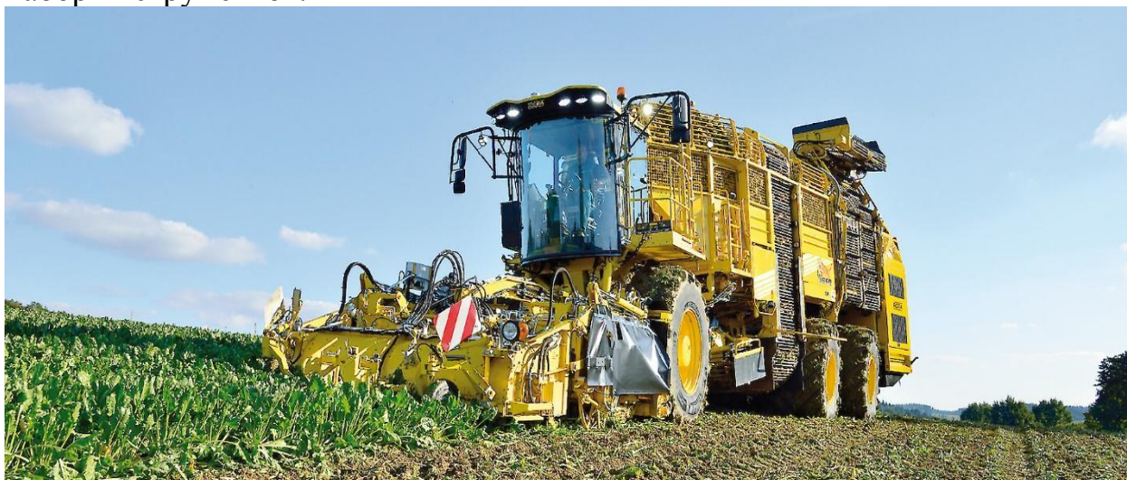
Рисунок 1 – Свеклоуборочный комбайн Ropa Tiger 5
