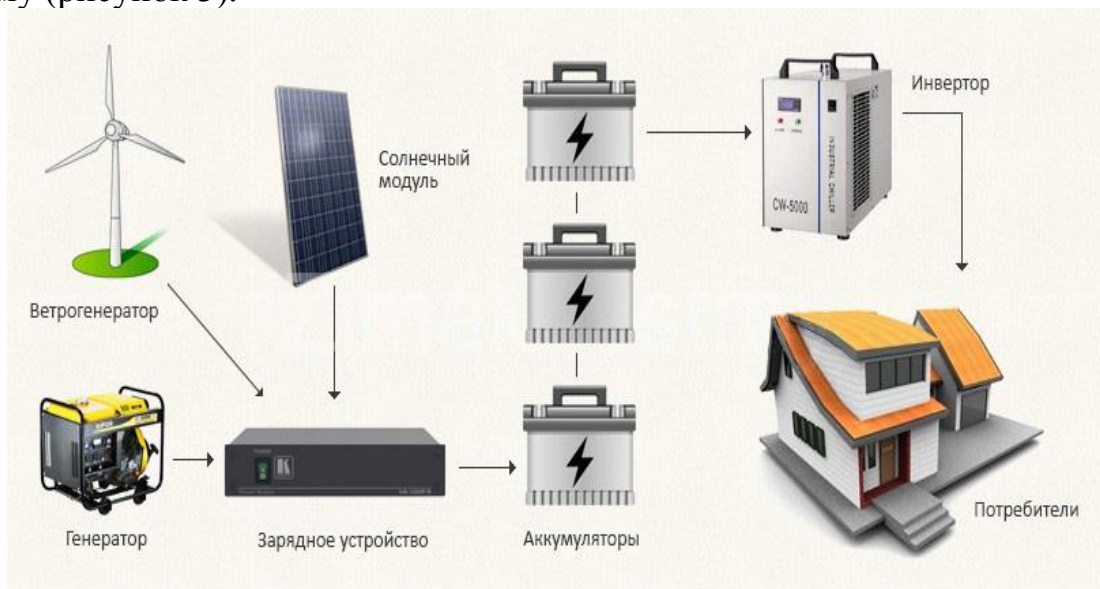
Рисунок 3 – Общая схема резервного электроснабжения частного дома
