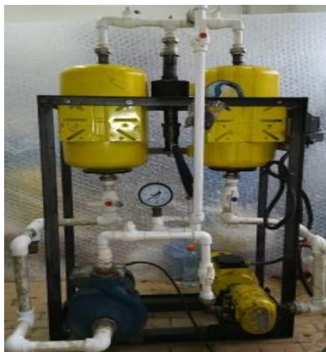
Рисунок 2 – Фото установки для получения смесевого топлива
