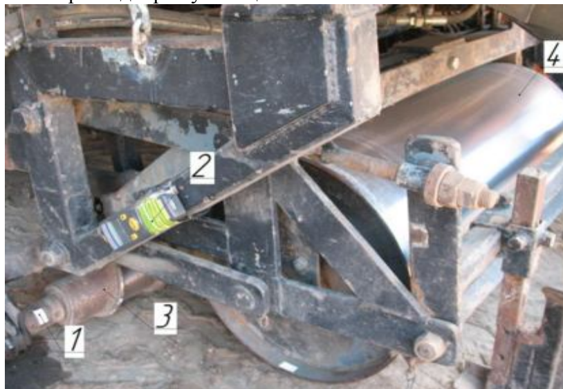
Рисунок 2 – Определение частоты вращения катка-ложеобразователя машины для уборки лука: 1 – полоса светоотражательная; 2 – фототахометр; 3 – валец спиральный; 4 – валец цилиндрический
