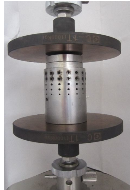
Рис. 1 Принципиальная схема (а) и внешний вид испытательного устройства (б), смонтированного в испытательной машине UAI-7000 М
