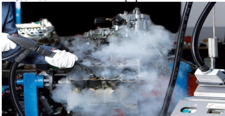
Рисунок 3 – Пароструйная обработка блока цилиндров двигателя автомобиля
