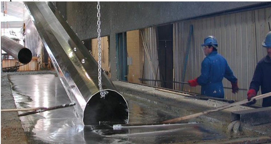
Рисунок 2 – Погружение металла в емкость с раствором
