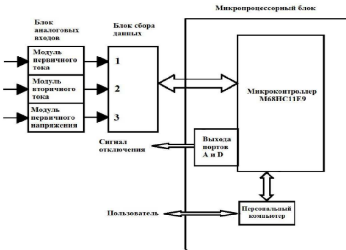
Рисунок 1 – Схема микропроцессорной релейной защиты
