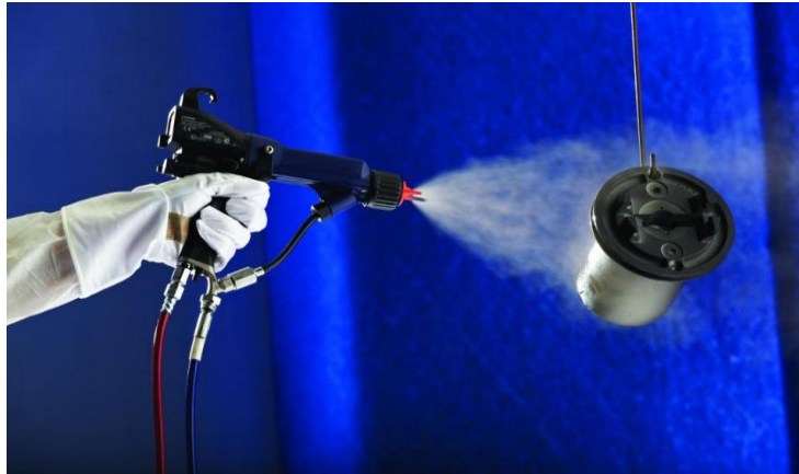
Рисунок 1 – Распыление раствора на поверхность изделия под малым давлением
