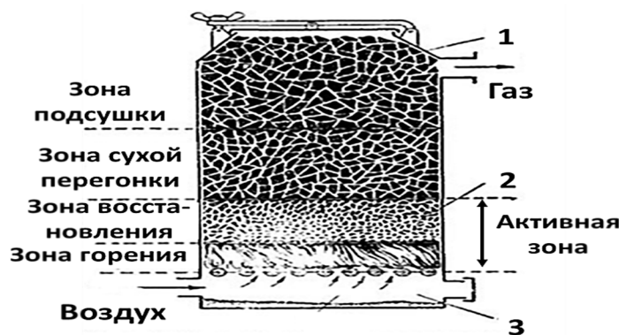
Рисунок 2 - Схема газогенератора прямого процесса газификации:
