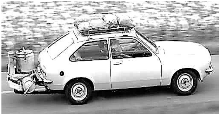
Рисунок 6 - Автомобиль Opel Kadett, оснащенный газогенераторным двигателем
