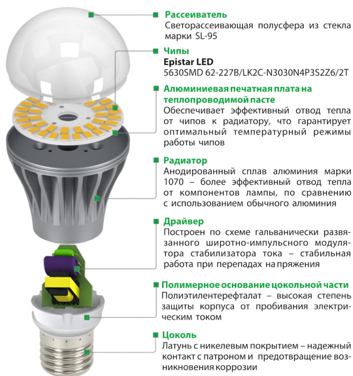
Рисунок 1. – Строение LED лампы на примере 1-LED-249
