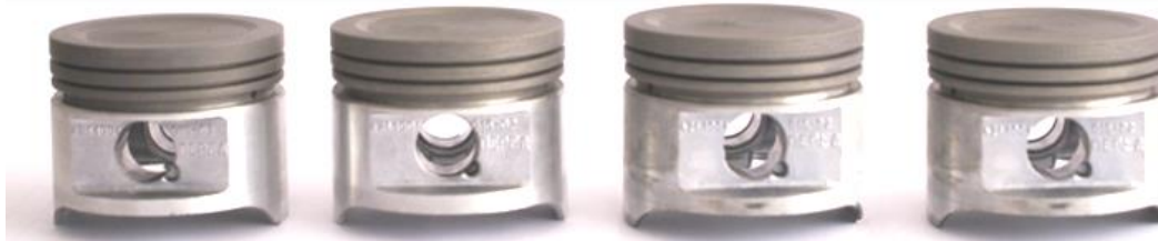
Рис. 1. Общий вид комплекта поршней с оксидированными рабочими поверхностями головок
