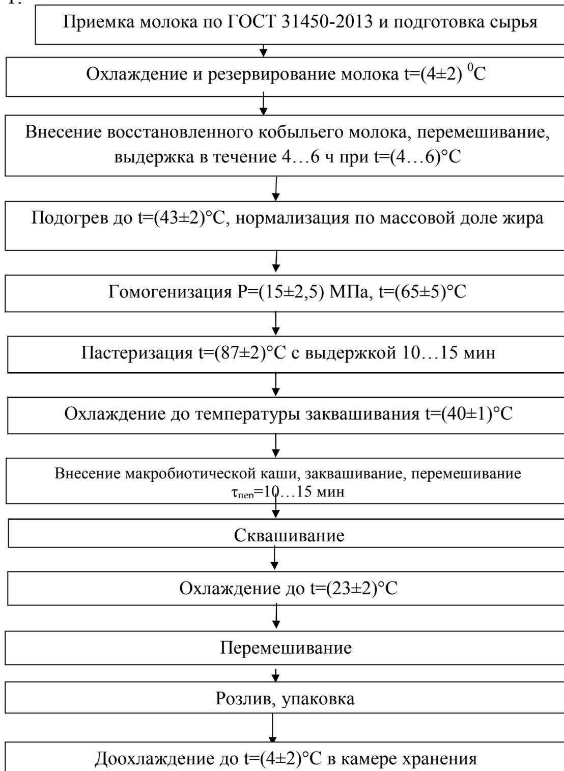
Рис. 1 Технологическая схема производства йогурта, обогащенного макробиотической кашей
