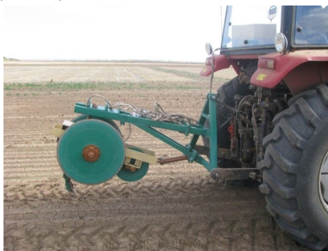
Рисунок 1- Макетный образец орудия для полосной глубокой обработки почвы.
