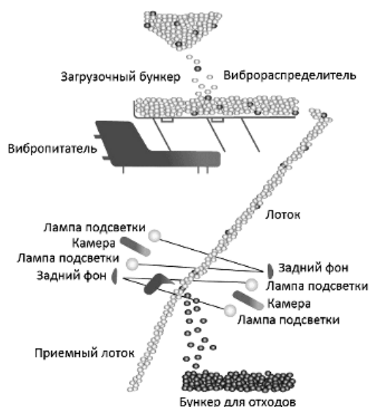
Рис.1 - Схема работы фотосепаратора
