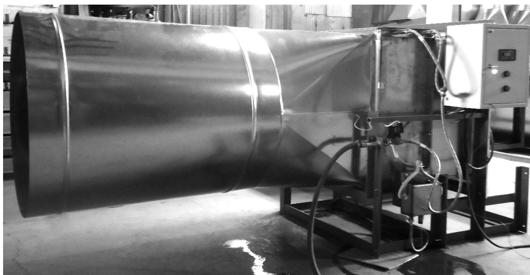
Рис. 6. Испытания пластинчатого водоиспарительного воздухоохладителя.
