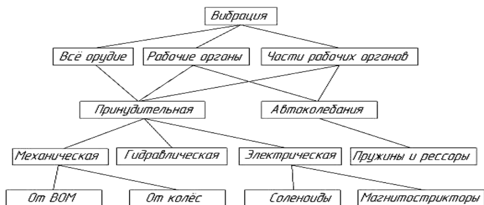
Рис. 1. Классификация способов образования вибрации почвообрабатывающей техники
